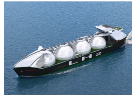
Flüssig Wasserstoff (-253°C) Tankschiff 160.000 m 3 → 11.200 Tonnen LH 2
